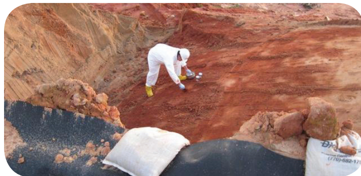
Un operario toma muestras de la tierra que va a quedar en el sitio para confirmar que está limpia.
